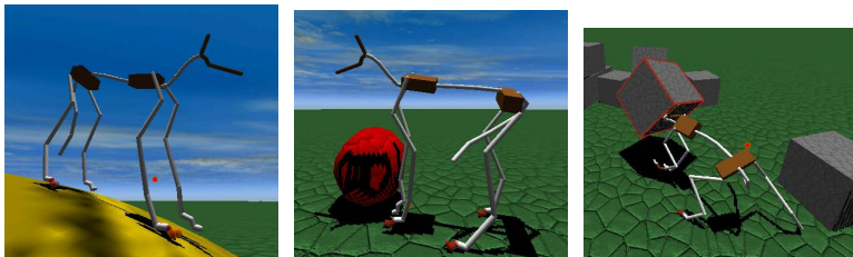
FIG.: Descente, poussée d'un ballon, et résistance face à un bloc projeté sur le quadrupède.
